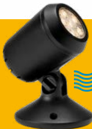
Подводный светильник Nilus [2105] ABS пластик - Черный LED 4Вт 3.000K - 400лм 129 x 95 x 109 мм (ДxШxВ)
