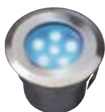
Sirius 4113601 Синий 1 Вт - 5 лм - A Нержавеющая сталь 316 52 x 70 мм (ДхШ) Отверстие для монтажа 60 мм Ø
