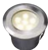
Sirius 4039601 Тёплый белый 1 Вт - 35 лм - A++ Нержавеющая сталь 316 52 x 70 мм (ДхШ) Отверстие для монтажа 60 мм Ø
