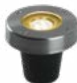
Umbra 3152051 Тёплый белый 3 Вт - 190 лм - A+ Нержавеющая сталь 85 x 105 мм (ДхШ) Отверстие для монтажа 70 мм Ø
