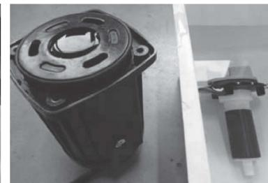
5. Установите корпус насоса в вертикальное положение и залейте мягким средством для удаления известковой накипи (например, очищающим уксусом). поместите ротор в пластиковую миску/контейнер, наполненный тем же средством для удаления известковой накипи, и оставьте на 24 часа. Через 24 часа смойте водой и снова соберите насос.
