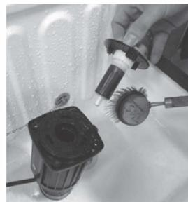
4. Выньте ротор и очистите его водой и щеткой
