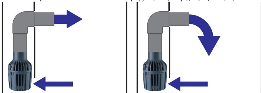
Насос имеет выпускное отверстие Ø110 мм, поэтому вы можете использовать стандартные трубы и фитинги из ПВХ (для отходов) диаметром 110 мм.
