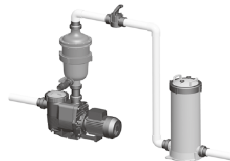
Установка с двухходовым запорным клапаном
