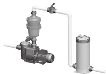
Типичная установка с картриджным фильтром
