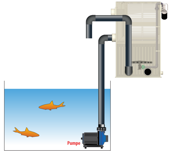
Beispiel pumpengespeiste Installation
