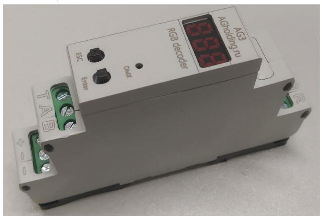
На плате декодера установлен светодиод HL7 монотонное мигание которого индицирует о наличии DMX сигнала.
