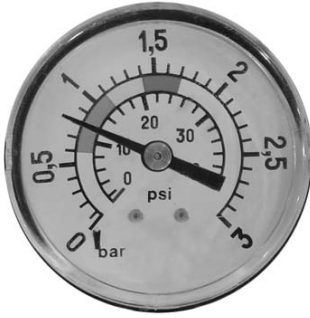
0,8 kg/cm 2 - 11,4 PSI: filitreleme sürecinin başındaki normal basınç
