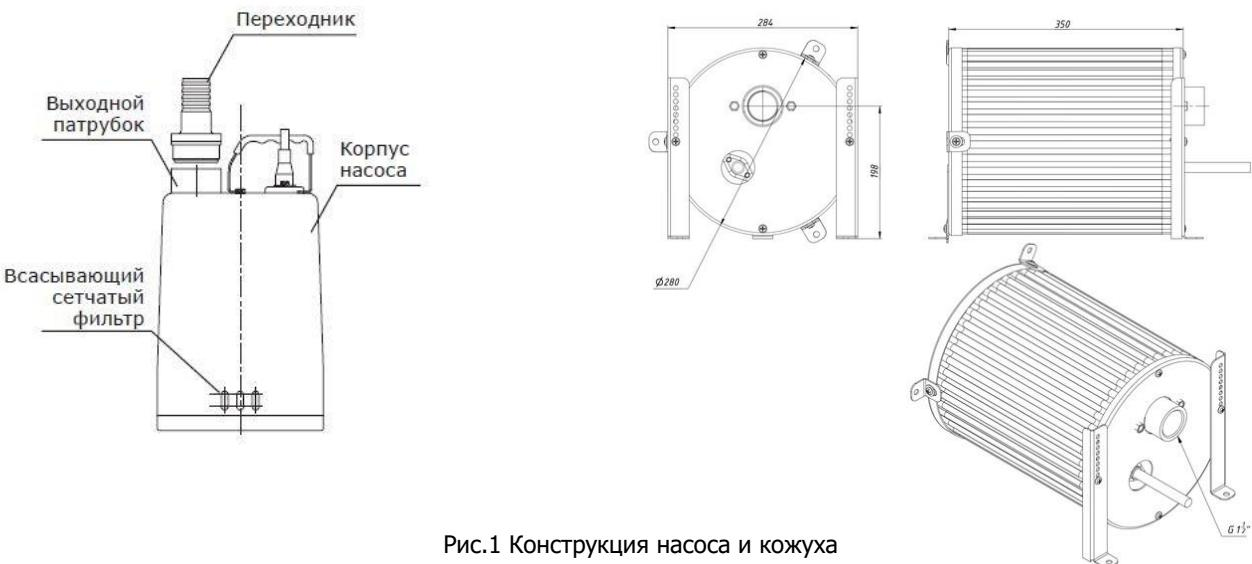
Рис.1 Конструкция насоса и кожуха
